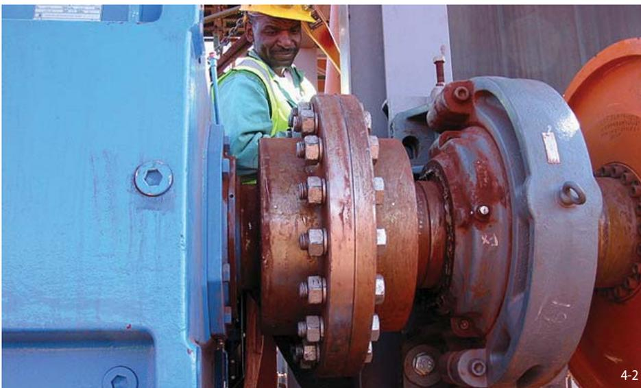
Tru-Line Flanschkupplung RFK 350 F - 350 M verbindet das Getriebe der Antriebseinheit mit der Kopftrommel einer Bandanlage zur Förderung von Eisenerz in Südafrika
