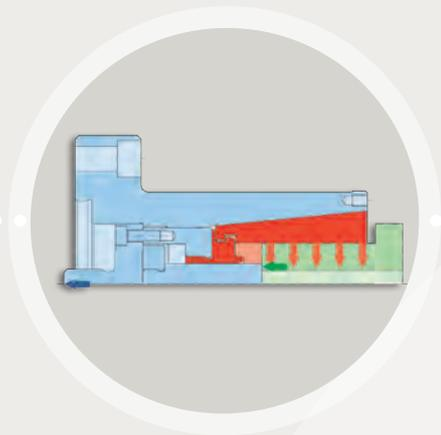
Zum Spannen wird die Kegelbüchse gegen die Aufnahme gezogen. Dabei wird das Werkstück zentriert, an die Anlagefläche gedrückt und dabei plan ausgerichtet.
