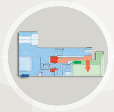
Zum Spannen wird die Kegelhülse gegen die Aufnahme gezogen. Dabei wird das Werkstück zentriert, an die Anlagefläche gedrückt und dabei plan ausgerichtet.
