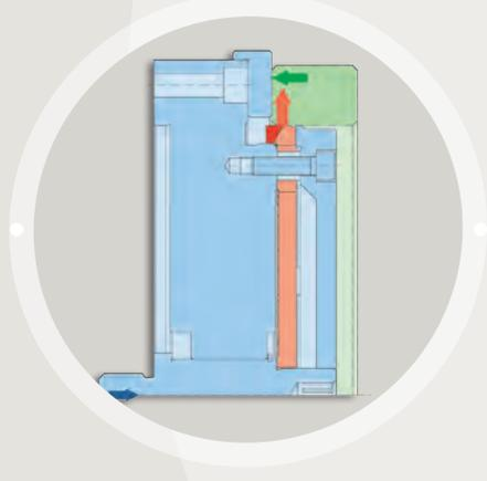
Der Flachkörper sitzt mit Vorspannung auf dem Stützdurchmesser der Aufnahme. Zum Spannen wird der Flachkörper mittels einer axialen Betätigungskraft elastisch verformt. Dabei wird das Werkstück zentriert, an die Anlage gedrückt und plan ausgerichtet.
