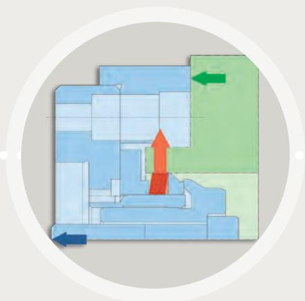
Der Scheibenblock sitzt mit Vorspannung auf dem Stützdurchmesser der Aufnahme. Zum Spannen wird der Scheibenblock durch Beaufschlagung einer axialen Betätigungskraft aufgerichtet. Dabei wird das Werkstück zentriert, plangenau an den Schulterring gedrückt und ausgerichtet. Durch die Kippung des Scheibenblocks wird die axiale Betätigung in eine bis zu 10 mal größere radiale Spannkraft übersetzt.
