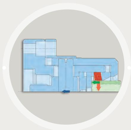
Der Scheibenblock sitzt mit Vorspannung im Stützdurchmesser der Aufnahme. Zum Spannen wird der Scheibenblock durch Beaufschlagung einer axialen Betätigungskraft aufgerichtet. Dabei wird das Werkstück zentriert, plangenau an den Schulterring gedrückt und ausgerichtet. Durch die Kippung des Scheibenblocks wird die axiale Betätigung in eine bis zu 10 mal größere radiale Spannkraft übersetzt.
