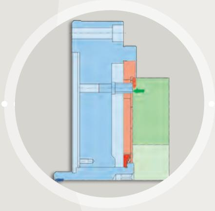
Der Flachkörper sitzt mit Vorspannung im Stützdurchmesser der Aufnahme. Zum Spannen wird der Flachkörper mittels einer axialen Betätigungskraft elastisch verformt. Dabei wird das Werkstück zentriert, an die Anlage gedrückt und plan ausgerichtet.
