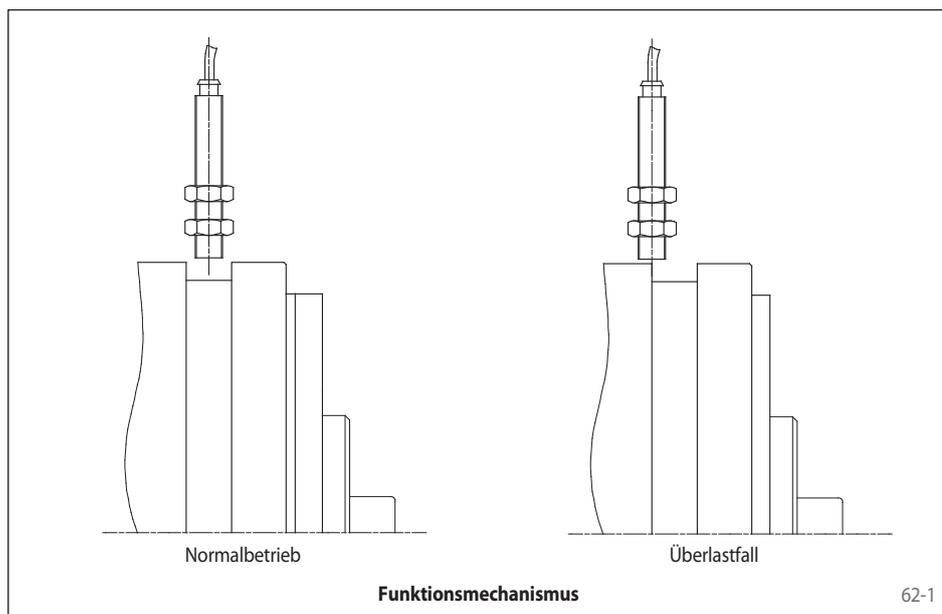
Bei SIKUMAT®-Drehmomentbegrenzern kann die Axialbewegung beim Überlastvorgang zur Betätigung eines Grenztasters genutzt werden. Dadurch kann beim Überschreiten des eingestellten Grenzdrehmoments der Antrieb elektrisch abgeschaltet und/oder ein Signal ausgelöst werden.
