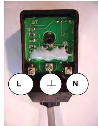
Bild 5.1 Anschluss der Stromversorgung
